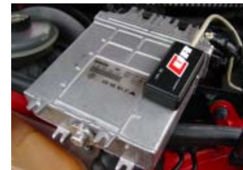
Řídicí jednotka má v sobě naprogramovaný nový software, za ní je ještě navíc připojen power-box. Společně dokáží zvednout výkon o 26 kW.
